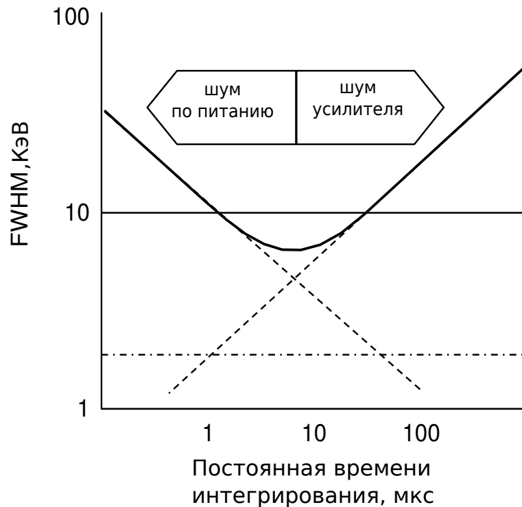
Рис. 2.7. Зависимость влияния шума, выраженное в увеличении энергетического разрешения, от постоянной времени интегрирования усилителя
