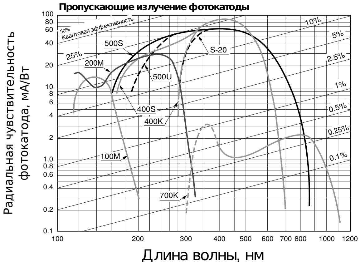
Рис. 1.5. Спектральная характеристика основных фотокатодов в режиме пропускания
